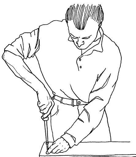
Figur 9. En skruvmejsel som inte är lämplig för den aktuella uppgiften eftersom den tvingar brukaren att lyfta överarmen kraftigt utåt.
